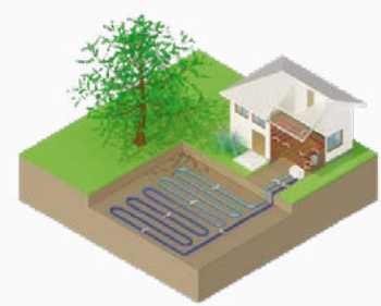
Pompe à chaleur sur capteurs enterrés horizontaux
