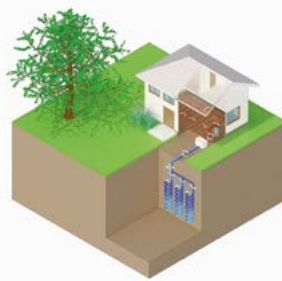
Pompe à chaleur sur corbeilles géothermiques
